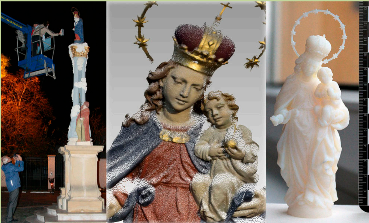
Mária szoborcsoport Szegeden. Tárgyszkennelés (balra), a földi szkennerek színezett pontfelhője (középen), 3D nyomtatott szobor (jobbra)
